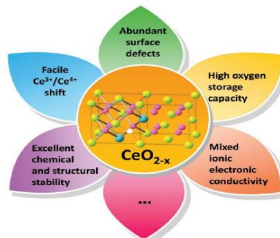
图 4 萤石结构的结构图和物理化学性质 [15]
